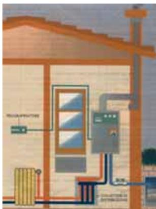
L'impianto di riscaldamento è costituito dal generatore di calore (caldaia) e dal sistema di distribuzione del calore (tubazioni e corpi scaldanti posti nei diversi locali dell'edificio).
